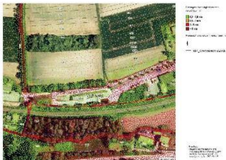
Abb. 2: Fließrichtung und Fließgeschwindigkeiten bei Starkregen (extrem, verschlammte)
